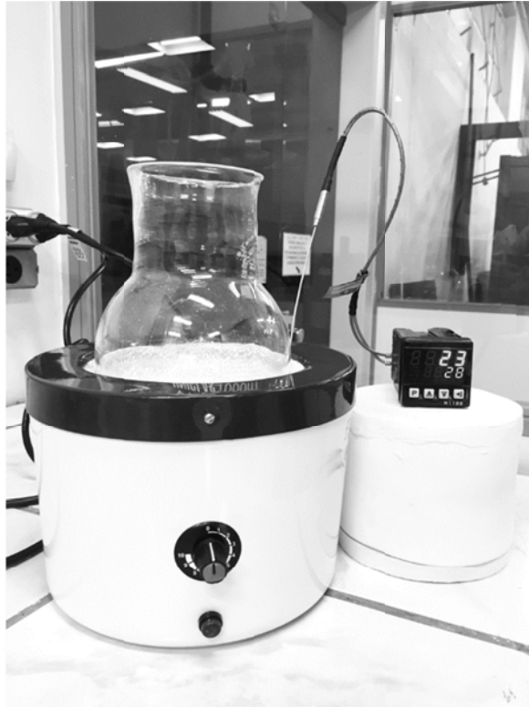
Figura 5. 2 – Manta aquecedora, balão de vidro de boca larga e o termopar tipo K acompanhado do registrador de temperatura utilizados no preparo da solução para a síntese por combustão em solução.
