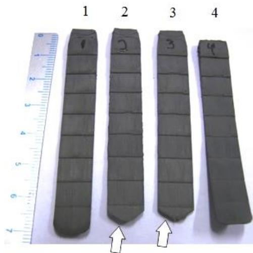
Figura 35: Corpos de prova moldados para avaliação do preenchimento do molde.
