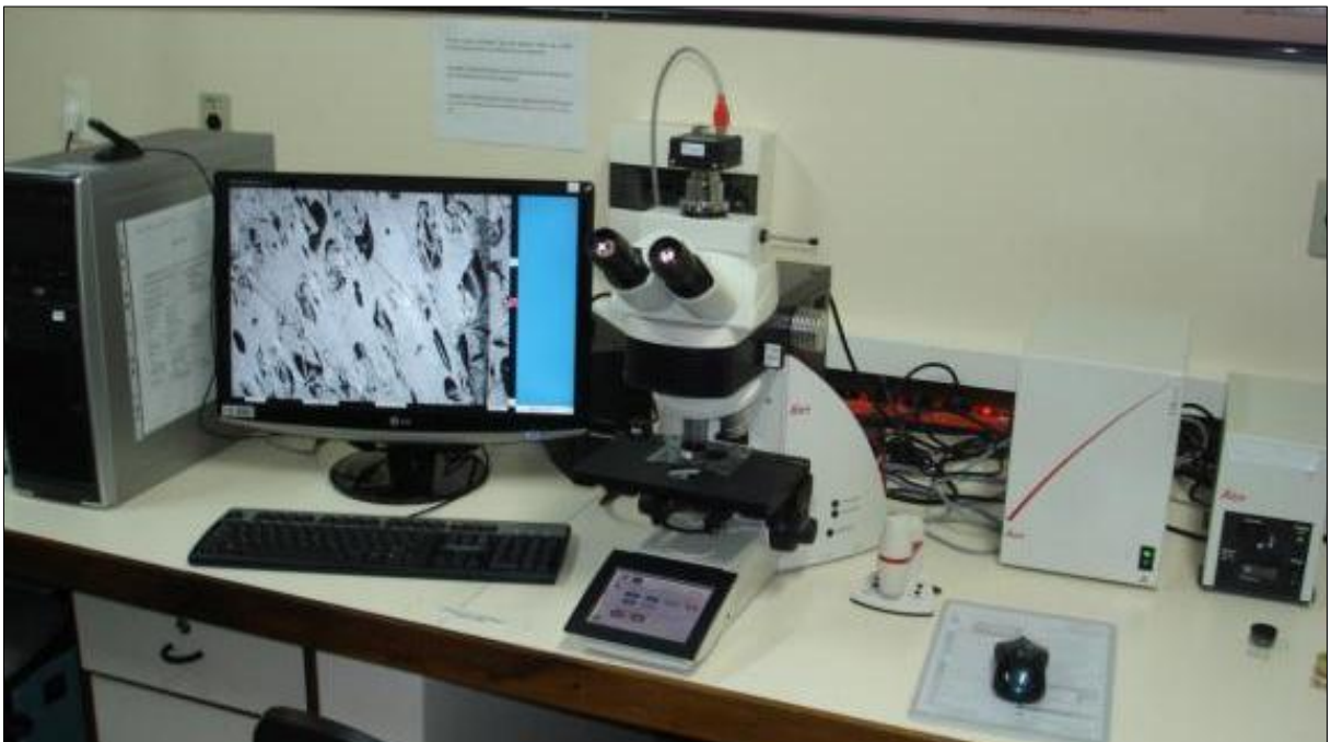
Figura 15: Microscópio Leica DM6000 M utilizado nas análises petrográficas no LACAPETRO - Laboratório de carvão e rochas geradoras de petróleo.
