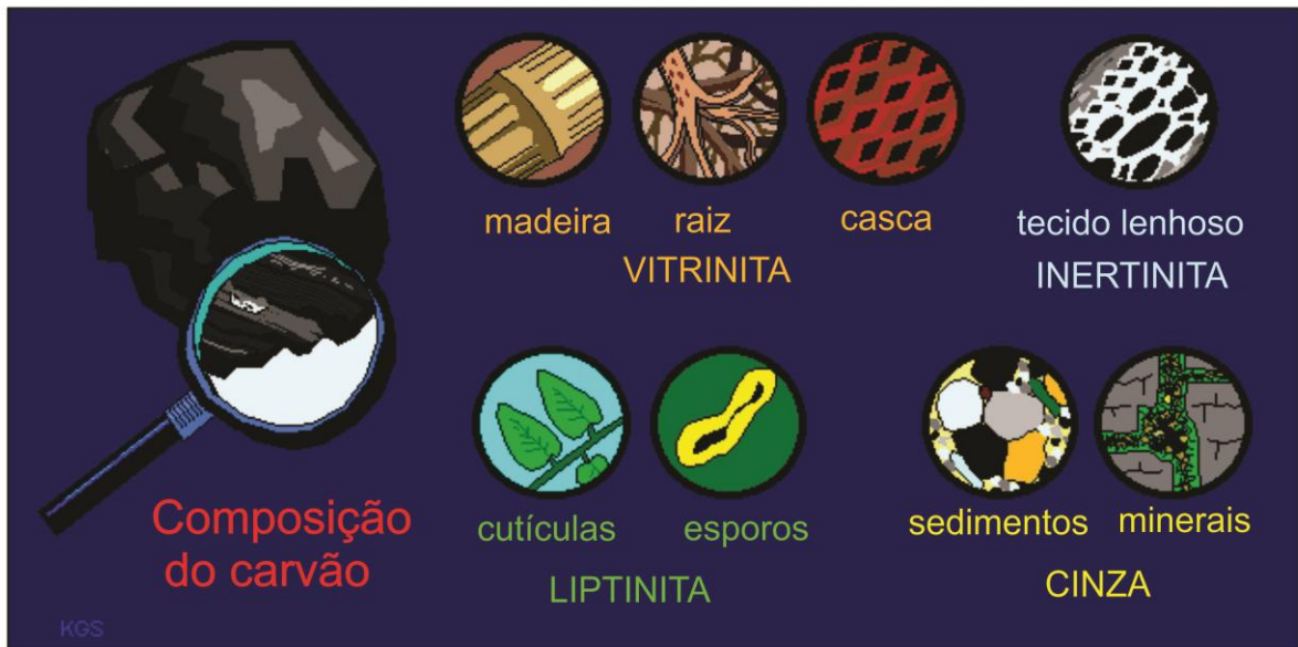
Figura 4: Macerais e suas origens vegetais (modificado de KGS, Disponível em: http://www.uky.edu/KGS/coal/coal_information.htm Acesso em: fev. 2016)
