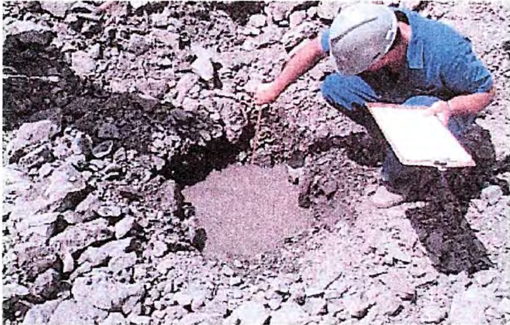
Figura 3.1: Ensaio de permeabilidade em cavas tipo Matsuo segundo normas da Associação Brasileira de Geologia de Engenharia (ABGE, 1996).
