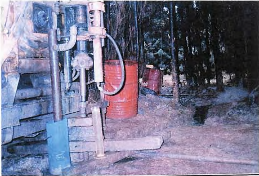
Figura 4.26: Equipamento para implantação de piezômetros com tubulação para ensaios de permeabilidade em furo de sondagem.
