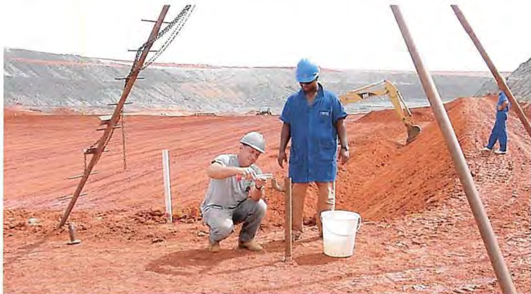
Figura 3.2: Ensaio de permeabilidade executado em furo de sondagem segundo padrões da Associação Brasileira de Geologia de Engenharia, ABGE (1996).
