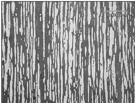
**Figura 4.3: Microestrutura do material do pino. Direção longitudinal. Ataque: Behara modificado.**
