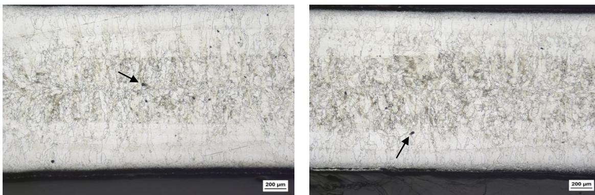
Figura 4.13 Pontos de solda com GAP de 0,87mm entre chapas, com um aumento de 50x. À esquerda o ponto de solda produzido com corrente constante e à direita o ponto de solda com corrente adaptativa. Presença de microporosidades - pontos pretos- exemplificados pelas setas.
