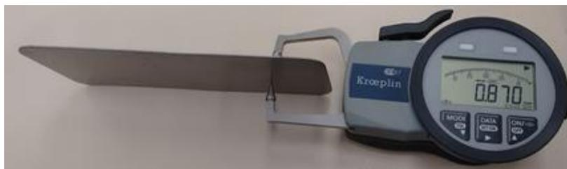
Figura 3.3 Espessura do recorte da chapa de aço, medida com especímetro Kroepelin Laengenmesstechnik C1X027.
