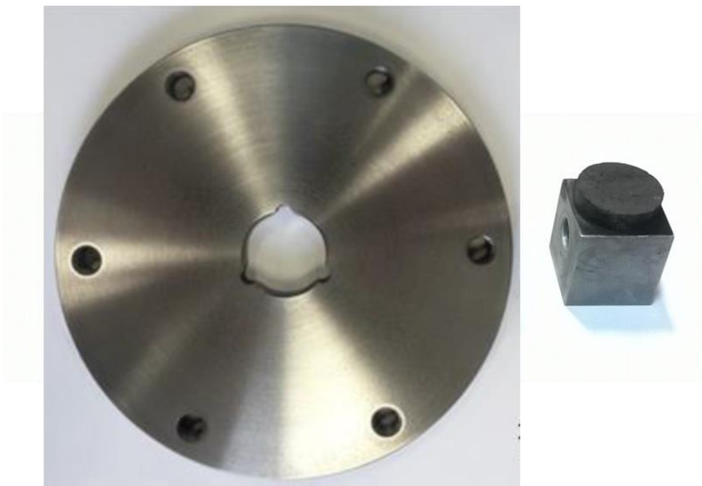
Figura 4.6 – Rotor (à esquerda) e corpo de prova (à direita).
