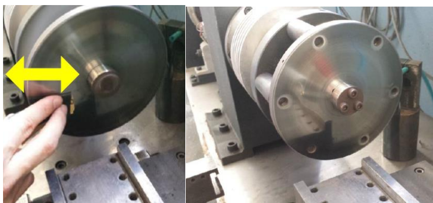
Figura 4.7 – Preparação da superfície do disco [cedido por Latrib].
