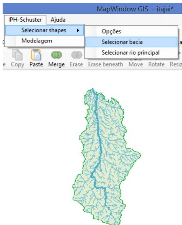
Figura 3.4. Seleção do shapefile do contorno da bacia hidrográfica no plug-in
