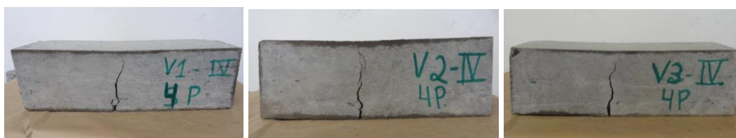
Figura 66: Fotos das três vigas no teor de 0,25% FF/65.
