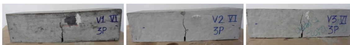
Figura 96: Fotos das três vigas no teor de 0,35% FF/65.
