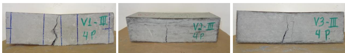
Figura 72: Fotos das três vigas no teor de 0,25% FF/80.
