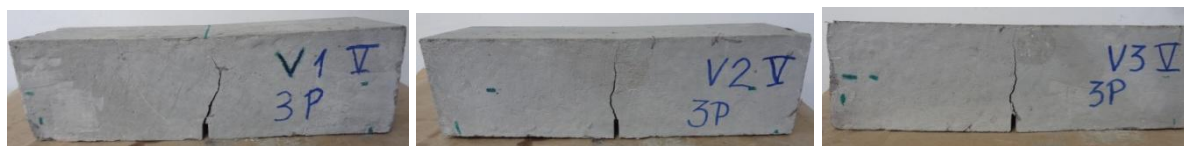
Figura 102: Fotos das três vigas no teor de 0,35% FF/80.
