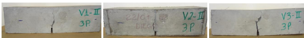
Figura 98: Fotos das três vigas no teor de 0,60% FF/65.
