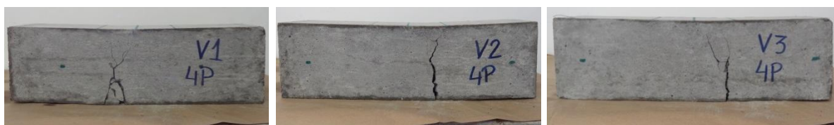
Figura 76: Fotos das três vigas no teor de 0,60% FF/80.
