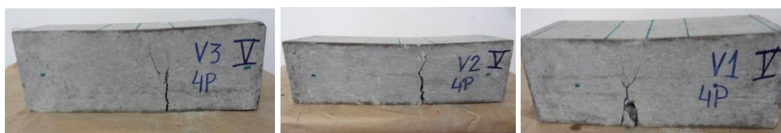
Figura 74: Fotos das três vigas no teor de 0,35% FF/80.
