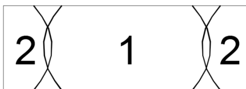
Figura 40: Ordem de colocação da mistura de concreto nas formas (JSCE, SF2, 1984).
