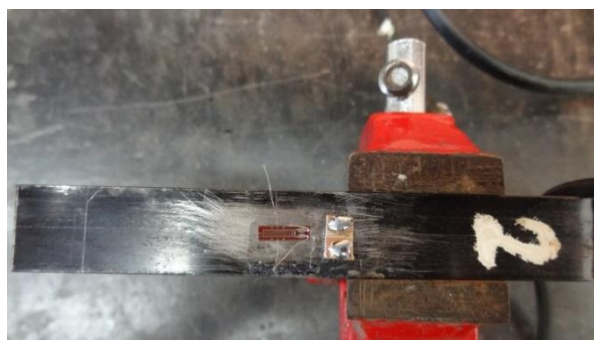
Figura 51: Instrumentação do clip gauge .
