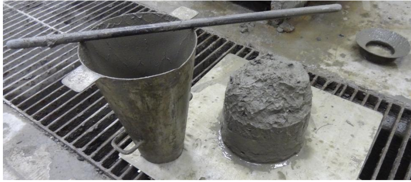
Figura 37: Ensaio de abatimento de tronco de cone após a inclusão das fibras.
