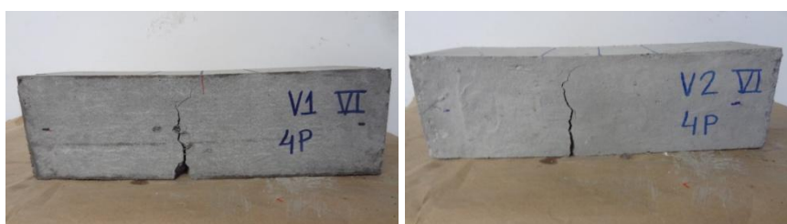
Figura 68: Fotos das duas vigas no teor de 0,35% FF/65.
