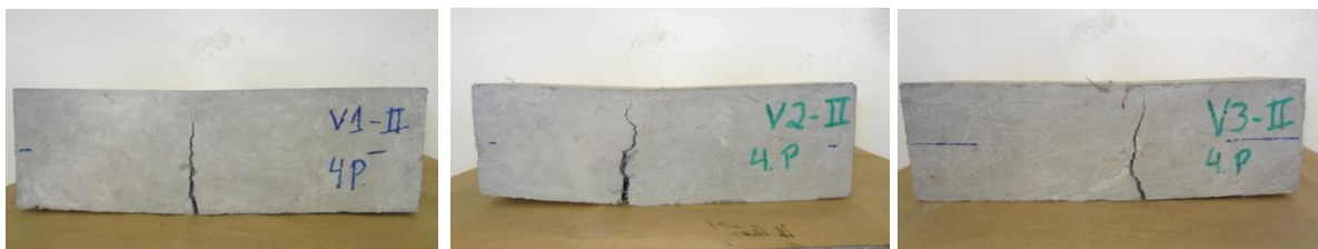
Figura 70: Fotos das três vigas no teor de 0,60% FF/65.
