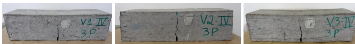
Figura 94: Fotos das três vigas no teor de 0,25% FF/65.
