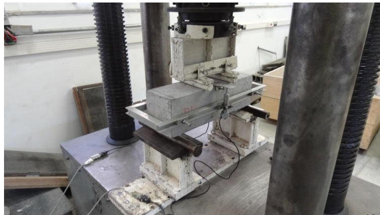
Figura 47: Ensaio flexão a 4 pontos em andamento.
