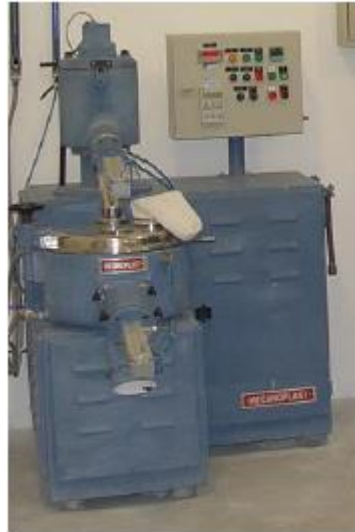
Figura 21: Misturador intensivo utilizado para mistura das formulações de PVC.
