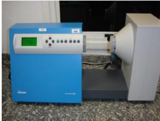
Figura 23: Equipamento BYK GARDNER modelo Haze-Garde.
