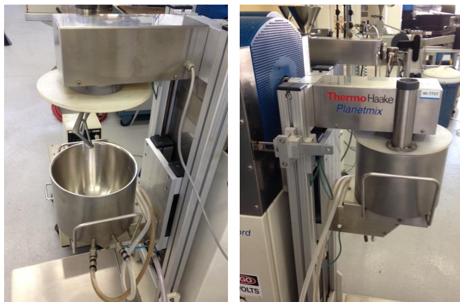
Figura 27: Misturador Planetário Haake (Planetmix)
