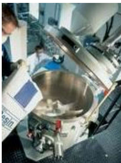
Figura 9: Imagem do misturador intensivo.
