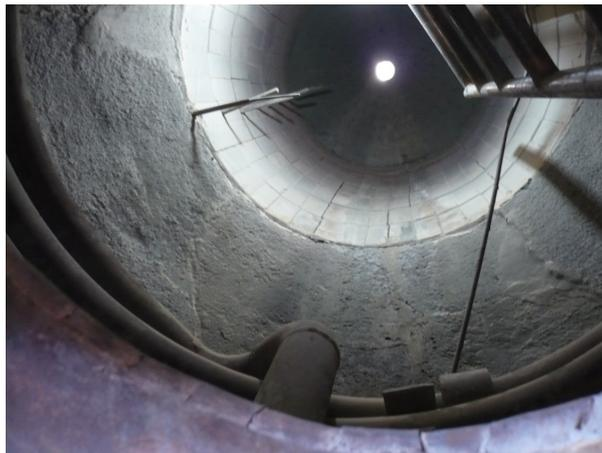
**Figura 3.2.** Interior do gaseificador de leito fluidizado borbulhante da CIENTEC.
