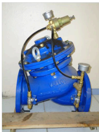
Figura 6 – Válvula redutora de pressão
