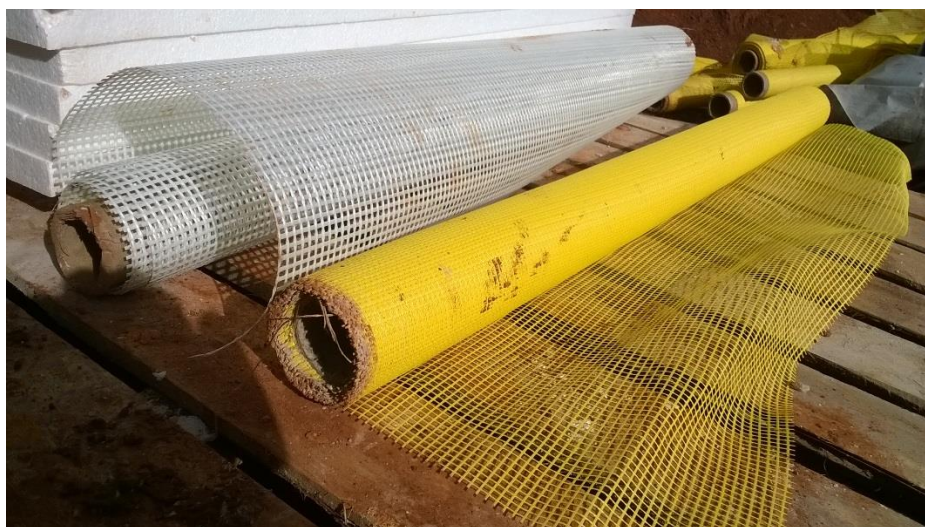
Figura 45 – Tela de reforço (branca) e tela de armadura (amarela)
