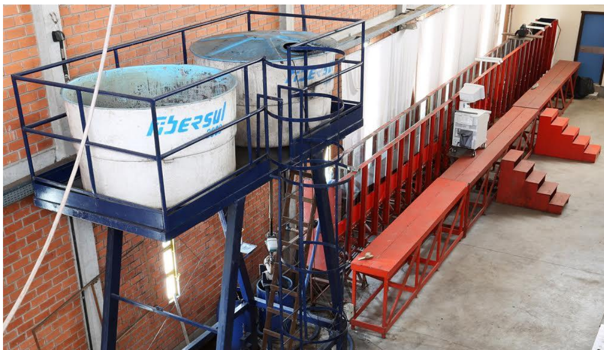
Figura 9 – Canal unidirecional de porte médio (CUMP) e tanques de armazenamento de mistura
