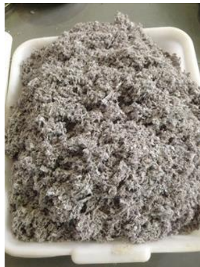
Figura 22 – Aspecto da serragem cromada após o processo, em laboratório, para redução das dimensões do material
