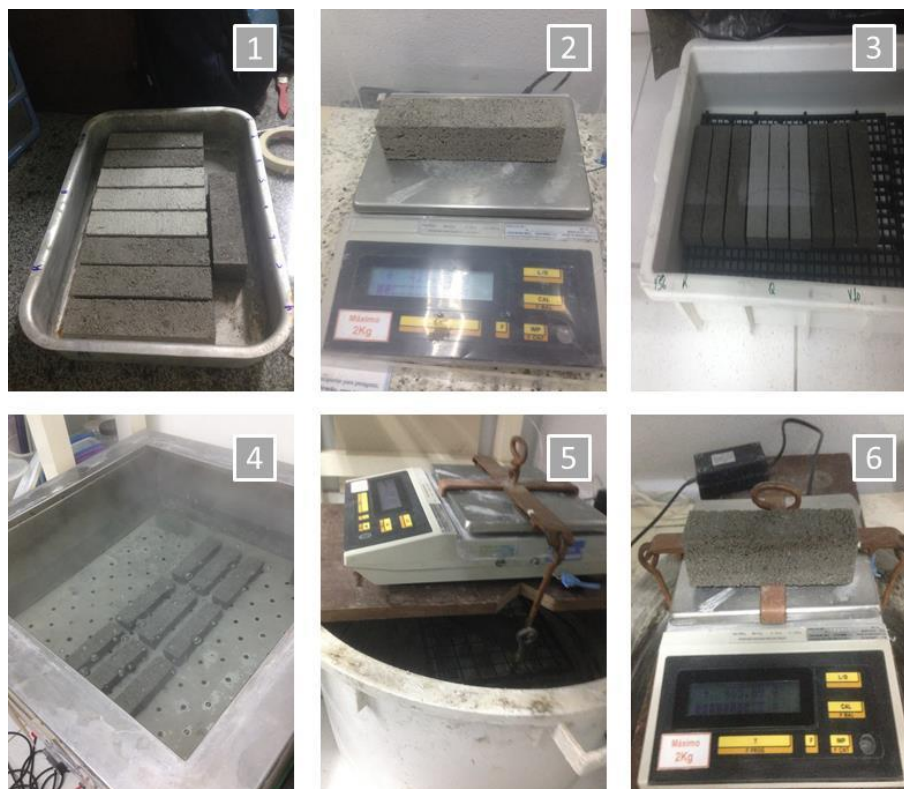
Figura 28 – Procedimento para a determinação da absorção de água, do índice de vazios e da massa específica das argamassas: (1) secagem dos corpos de prova em estufa; (2) pesagem dos corpos de prova secos; (3) imersão dos corpos de prova em água em temperatura controlada; (4) imersão dos corpos de prova em água em ebulição; (5) pesagem dos corpos de prova imersos em água em temperatura controlada; (6) pesagem dos corpos de prova com a superfície enxugada
