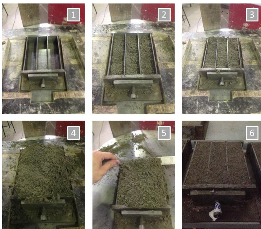
Figura 26 – Procedimento de moldagem dos corpos de prova de 4 x 4 x 16 cm: (1) introdução do molde na mesa de adensamento; (2) preenchimento e nivelamento da primeira camada; (3) adensamento da primeira camada; (4) preenchimento e nivelamento da segunda camada; (5) adensamento da segunda camada e rasamento da superfície; (6) aspecto final dos corpos de prova no molde
