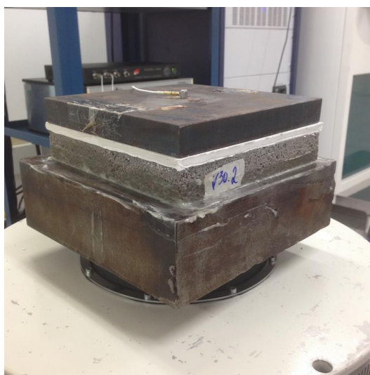
Figura 35 – Amostra pronta para o ensaio de rigidez dinâmica
