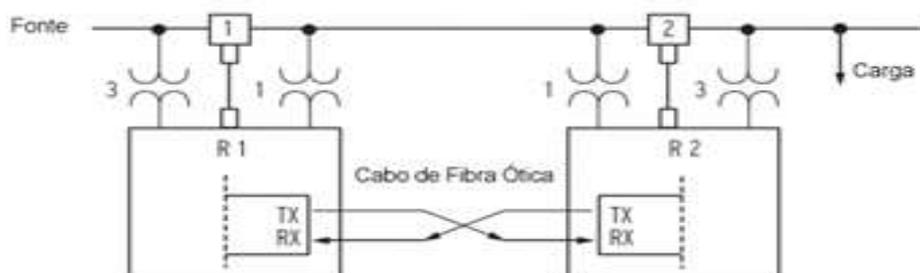
A segunda forma, bastante praticada nas distribuidoras e não requer nenhum sistema adicional é o ajuste das curvas de tempo definido como ilustra a Figura 8. Exemplificando, o tempo de religamento do religador 1 a montante é ajustado para 100 ms e o religador 2 é ajustado em 60 ms, tempo necessário para atuação do religador 2, início de contagem do
