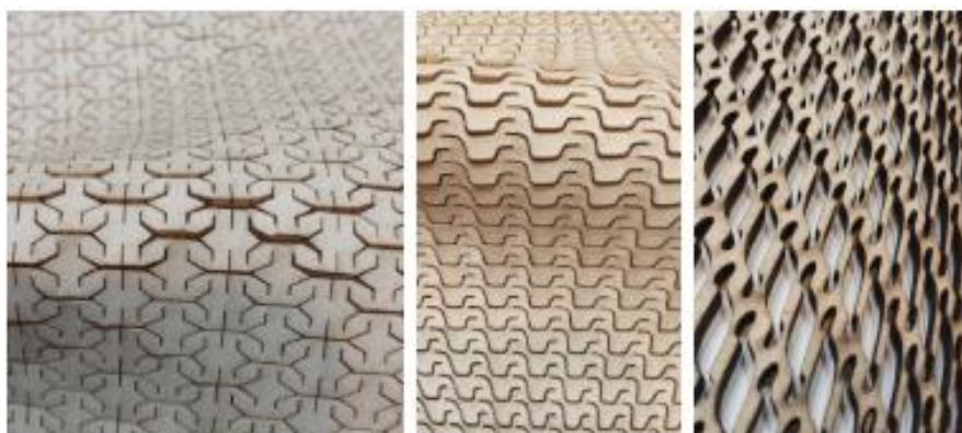
Figura 28: a) padrão com ângulos. b) Padrão curvo. c) Padrão com cantos arredondados. Fonte: DIYOURSELF, 2015.
