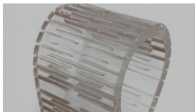
Figura 26: detalhe das dobradiças estruturadas aplicadas em acrílico. Fonte: DIYOURSELF, 2015
