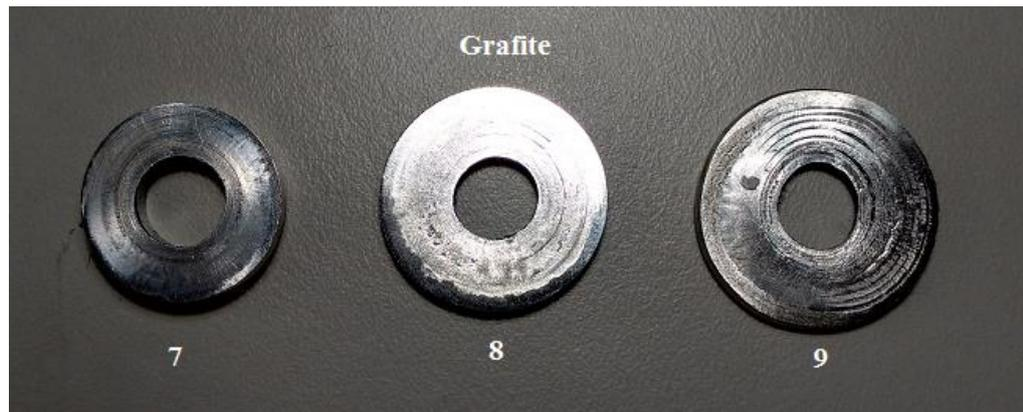
Figura 27 - Corpos de prova após ensaio do anel, lubrificados com grafite.
