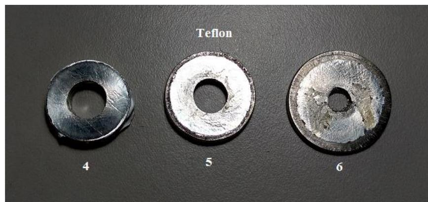
Figura 26 - Corpos de prova após ensaio do anel, lubrificado com teflon.
