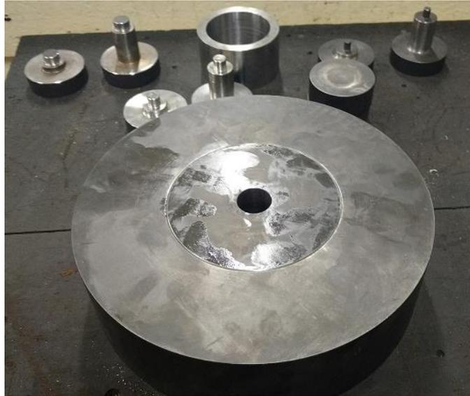
Figura 20 - Conjunto ferramental para o ensaio do anel e DCET.
