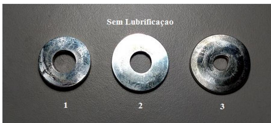
Figura 25 - Corpos de prova após teste de anel, sem lubrificação.
