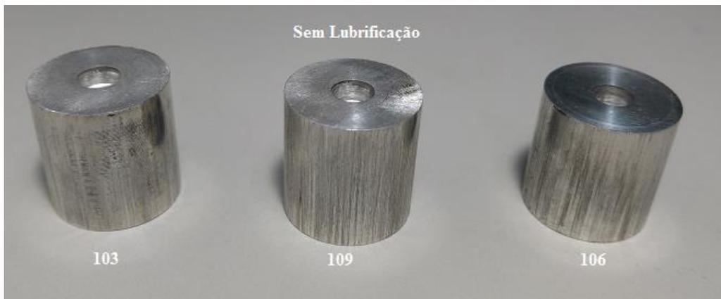
Figura 29 - Corpos de prova após DCET, sem lubrificação.
