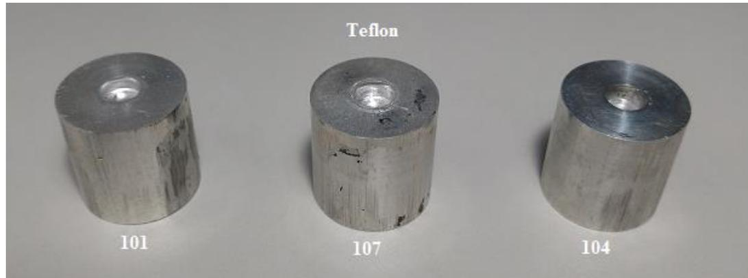
Figura 30 - Corpos de prova DCET, lubrificados com teflon.
