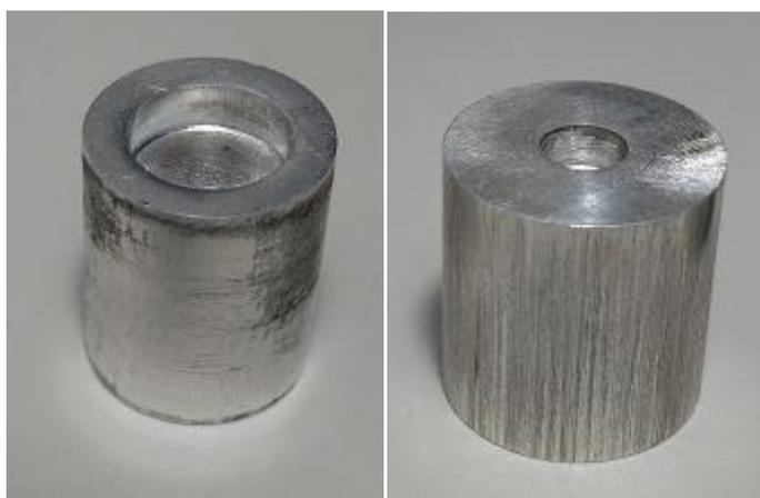
Figura 38 - Corpos de prova extrudado com ferramentas diferentes.
