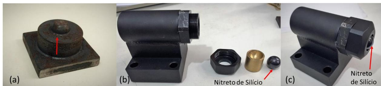
Figura 4.2 – (a) Pino de aço mola; (b) suporte para a esfera de nitreto de silício: desmontado e (c) montado.
