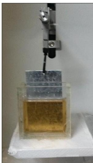
Figura 14. Processo de imersão utilizado para as amostras.
