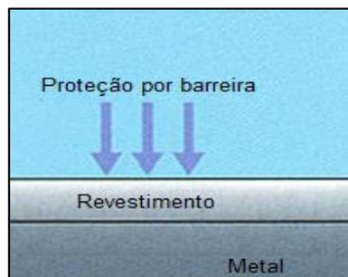
Figura 6. Mecanismo de proteção do silano.
