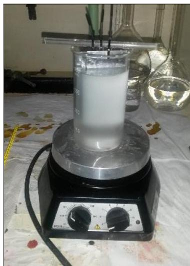
Figura 13. Esquema de desengraxe das chapas galvanizadas.
