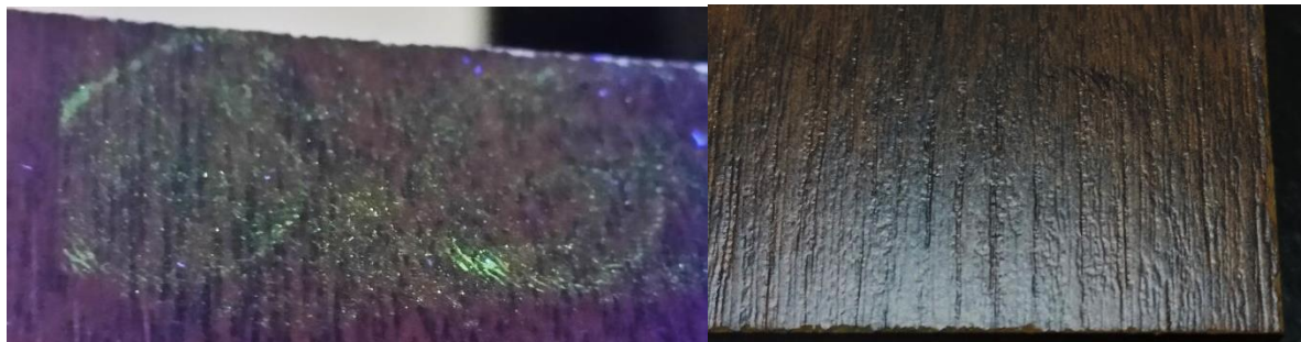
Figura 71: Comparação das últimas marcações das duas fileiras, uma revelada com HB-7 (esquerda) e outra com Amido Black (direita).
