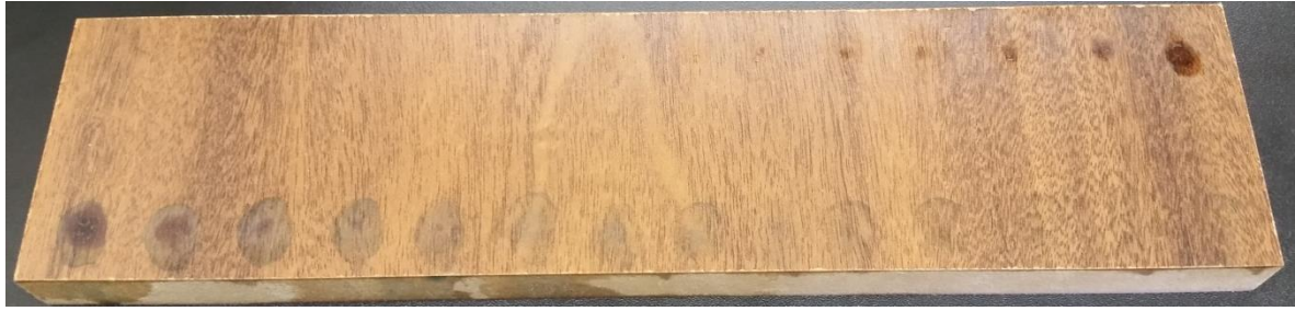
Figura 69: Imagem das marcas sequenciais de sangue em madeira. Revelação das marcações da fileira inferior com Amido Black.
