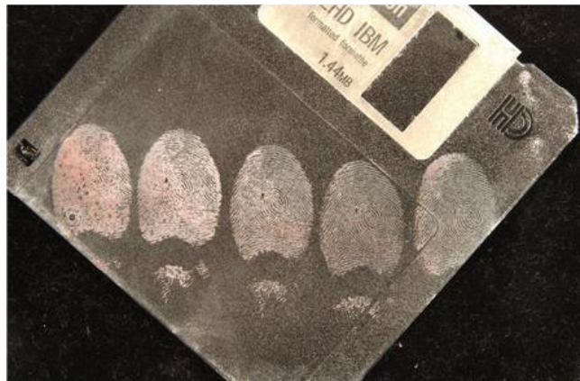
Figura 30: Utilização da suspensão de Dióxido de Titânio para revelar digitais com sangue em um disquete de computador (61) .
