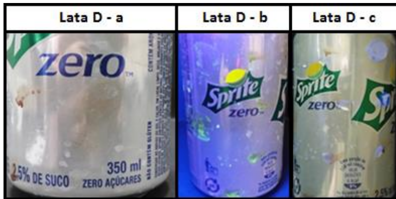
Figura 81: Revelação em sequência da lata D. Cianoacrilato (a), HB-7 (b) e Luminol (c).
