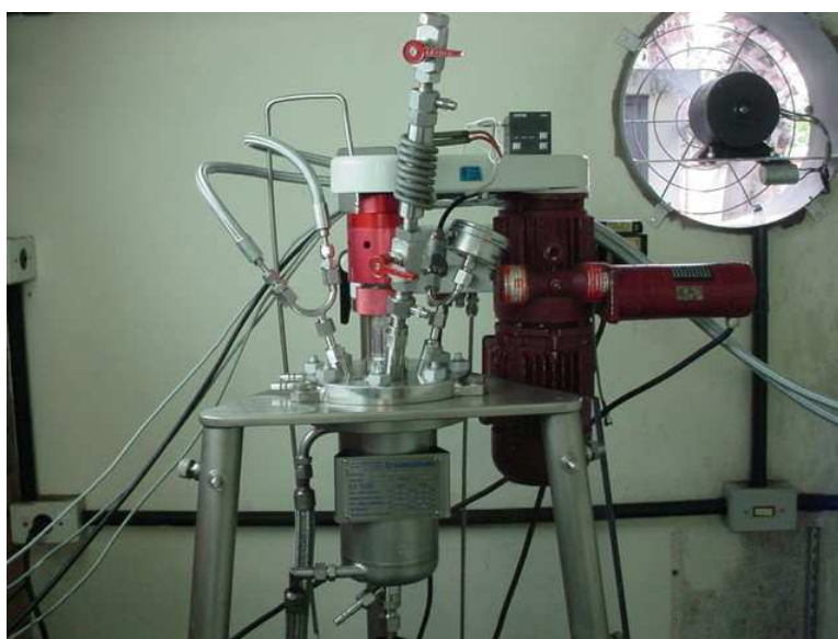
Figura 7. Reator de aço de 1 L (Büchi) com ampola de adição sob pressão.
