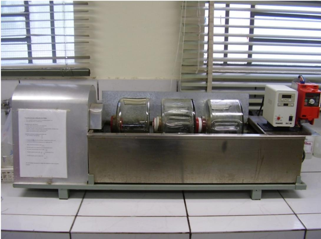
**Figura 3.4:** Sistema de fulão utilizado nas etapas de acabamento molhado.
