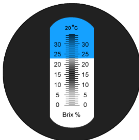
Figura 2.4: Exemplo de leitura da lente de um refratômetro simples, indicando uma solução com 23°Bx (Adaptado de: Grapestompers, s.d.).
