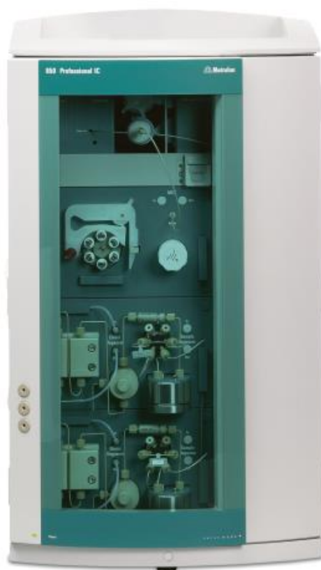
Figura 2.8: Cromatógrafo modelo 850 Professional IC, marca Metrohm, utilizado por Pico et al. (2014) (Adaptado de University of Massachusetts Amherst, s.d.).
