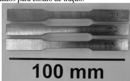
Figura 3.12 – Corpos de prova usinados para ensaio de tração.
