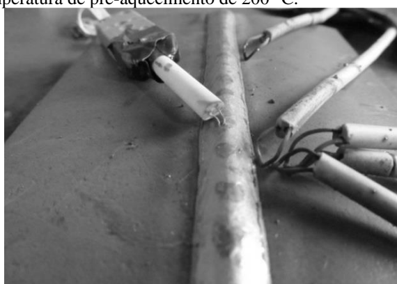
Figura 3.8 – Termopar tipo S fixado no metal de solda e termopares tipo K fixados na superfície da amostra soldada com temperatura de pré-aquecimento de 200 °C.
