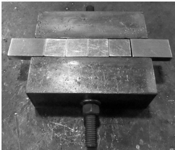
Figura 3.7 – Corpos de prova posicionados antes da realização da solda para determinação do nível de hidrogênio difusível.
