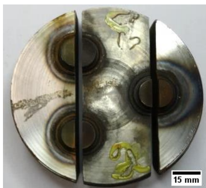
Figura 34 – Soldas de definição de parâmetros seccionadas por eletroerosão.
