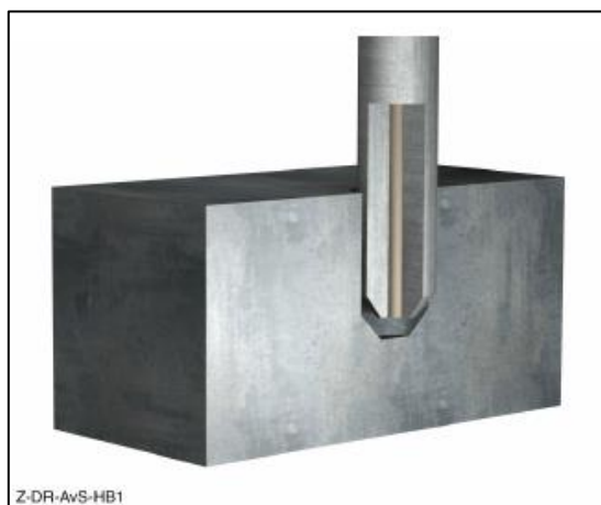
Figura 18 – Geometria do pino e base com traçador de níquel (MEYER, 2003).
