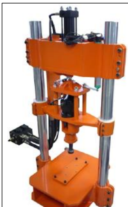
Figura 30 – Equipamento para soldagem por fricção MSA 50 (ANDRADE, 2011).
