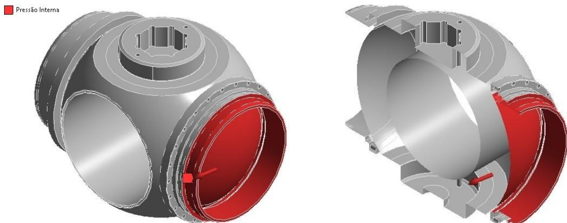
(c) Pressão interna aplicada na esfera e porta-sede na condição pistão simples efeito (SPE)
