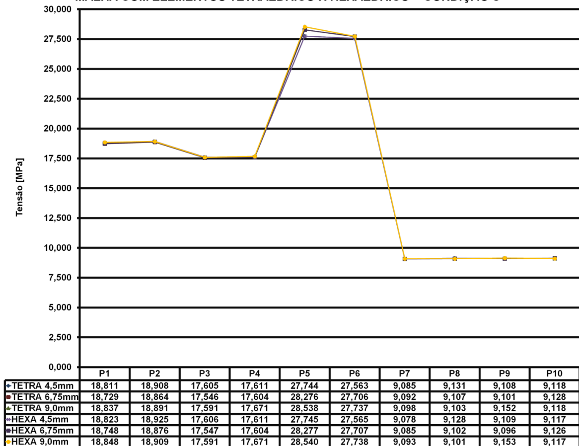
Figura C.8 – Resultados comparativo de tensões equivalentes para a condição de carregamento C MALHA COM ELEMENTOS TETRAÉDRICO X HEXAÉDRICO - CONDIÇÃO C
