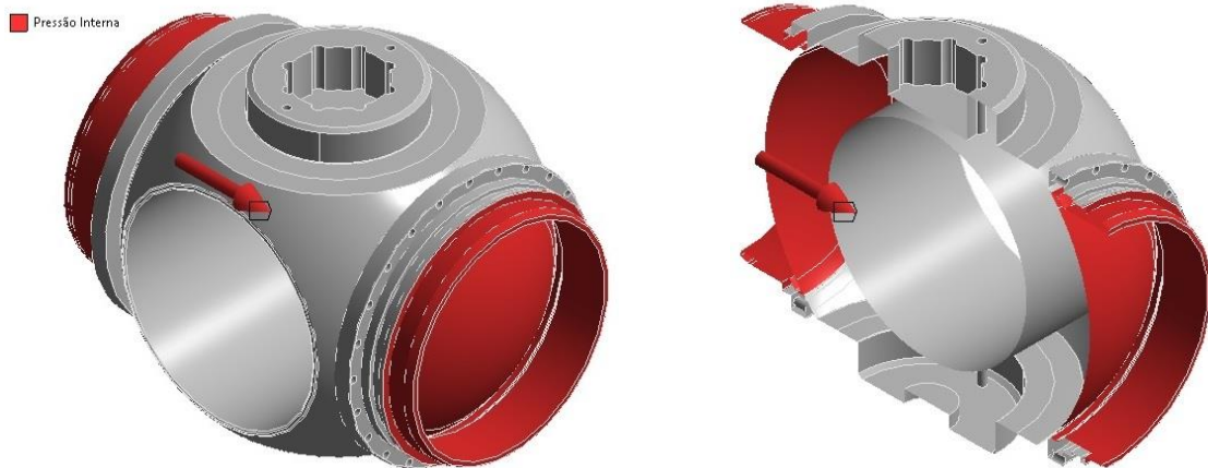
(b) Pressão interna aplicada na esfera e porta-sede na condição duplo bloqueio (DBB)
