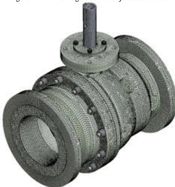
Figura B.1 – Malha gerada no conjunto da válvula
