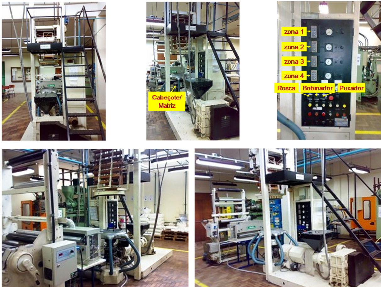
Figura 20. Linha de extrusão de filme tubular utilizada no estudo: marca Carnevalli, modelo B700, Série B, ano 1985.
