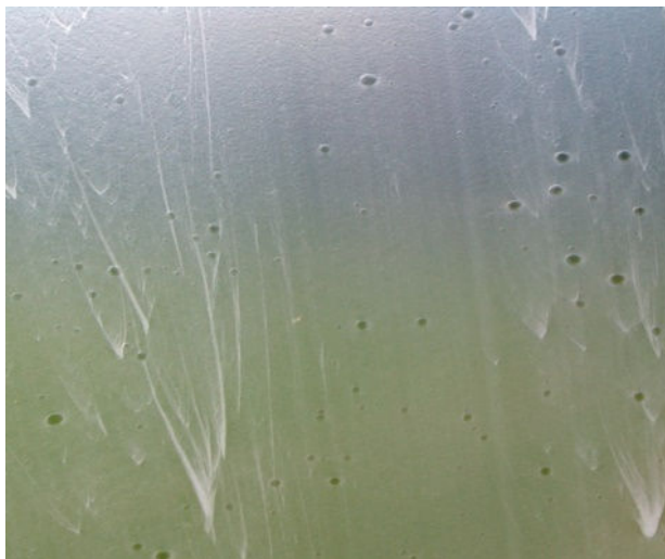
Figura 45. Imagem do filme PP10B50-9-2,5 com marcas de fluxo e olhos de peixe nos processamentos de 09/03/2015.
