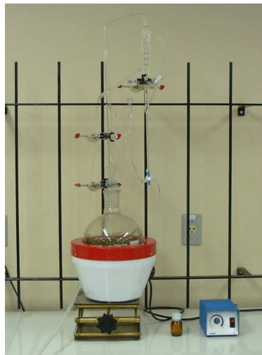
FIGURA 2.2 Aparelho de destilação tipo Clevenger. Faculdade de Agronomia – UFRGS, Porto Alegre, 2008.
