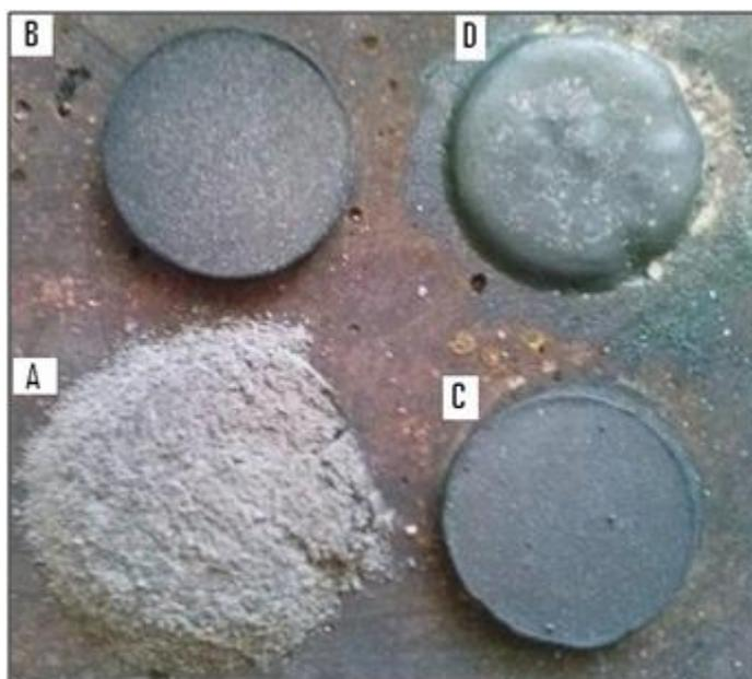
Figura 6.38 - Aspecto visual dos corpos de prova sinterizados a 1400°C. (a) 100% C<sub>2</sub>S; (b) C<sub>2</sub>S + 5% CaF<sub>2</sub>; (c) C<sub>2</sub>S + 10% CaF<sub>2</sub> e (d) C<sub>2</sub>S + 20% CaF<sub>2</sub>.
