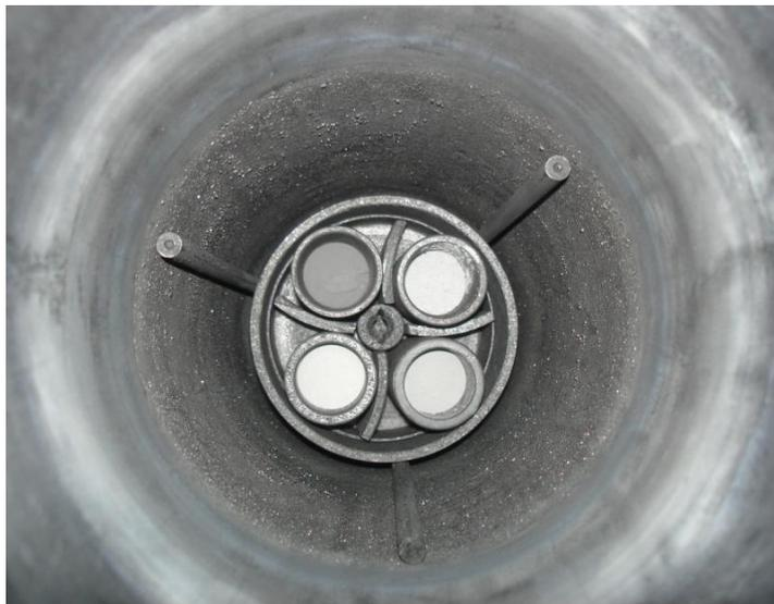
Figura 5.4 - Imagem dos cadinhos de grafita (alta pureza) dentro do tubo vertical constituído do mesmo material. Os cadinhos apresentam a mesma dimensão, conforme segue: diâmetro externo (45mm), diâmetro interno (32mm), altura interna (50mm) e altura externa.
