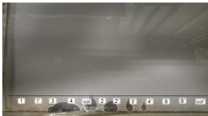
Figura 1: Teste da Cromatografia em TLC das soluções padrões com o sistema de dupla migração sequencial de Salame-Méndez (2012). Nos pontos 1 e 1' aplicou-se o ácido deidrocolico; 2 e 2', ácido litocolico; 3 e 3', ácido colico; 4 e 4' glicocolico; col e col', colesterol; e, por fim, a mistura de todas as soluções padrões em S e S'. Para os pontos 1, 2, 3, 4, col e S foi aplicada um volume de 5µL e, para 1', 2', 3', 4', S' e col', de 10µL. A linha representa o ponto de partida da corrida.
