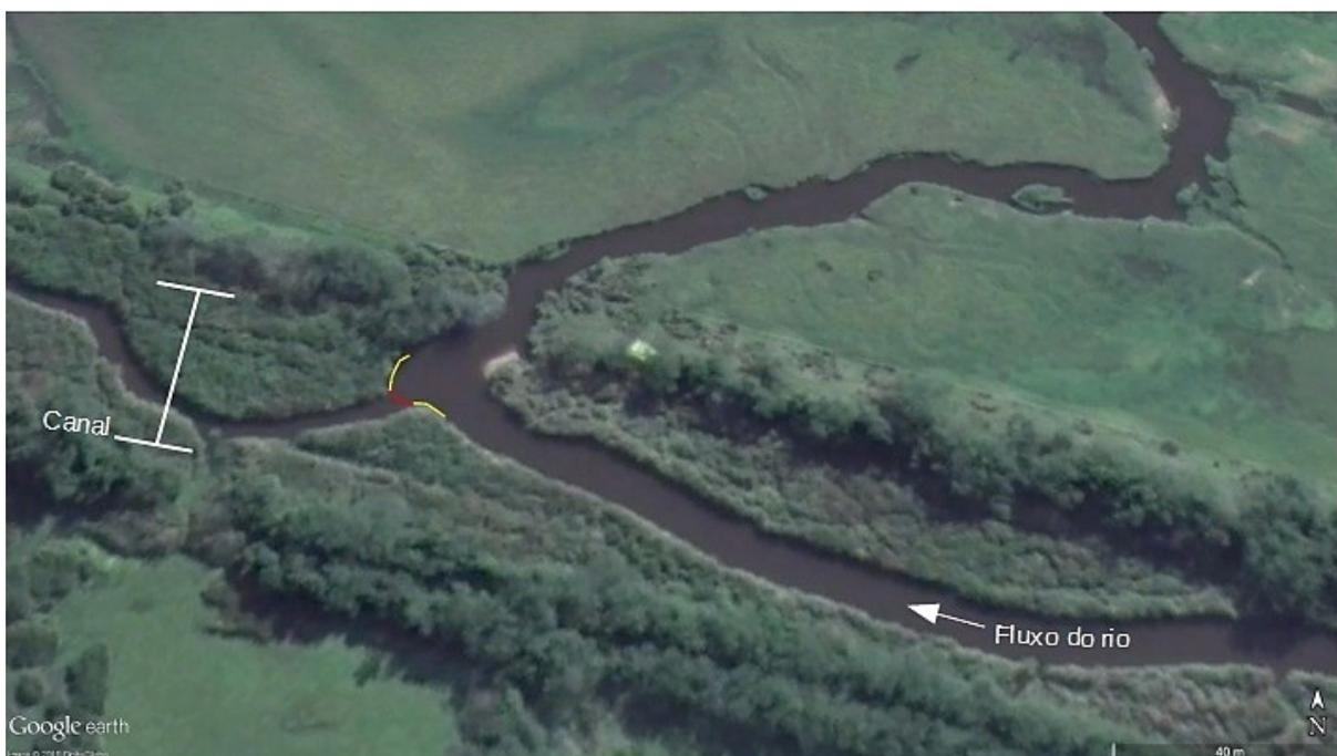
Figura 39 - Ponto 1: em amarelo local para construção da trança-viva, em vermelho local das sacas de areia para redirecionamento do fluxo.
