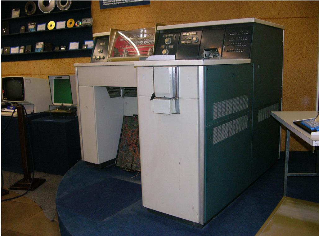
**Fotografia 1** - UNIVAC 1005 III – Card Processor
