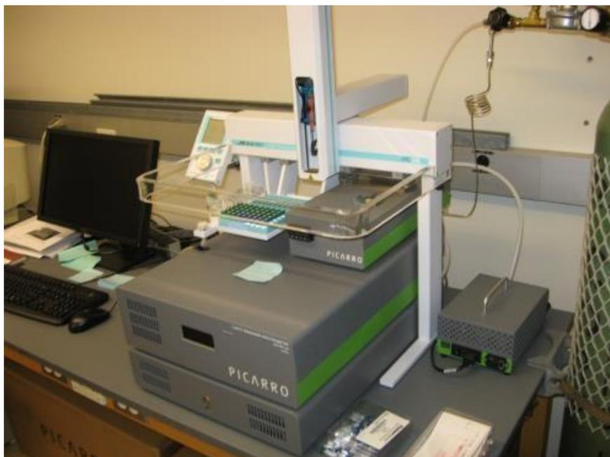
**Figura 15:** Espectrômetro tipo CRDS Picarro LD 2130i
