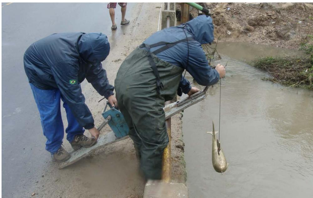
Figura 3 – Primeira medição de descarga sólida da estação Arroio do Salso em 27/08/2013.
