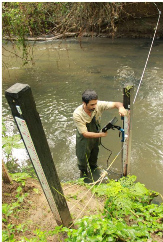
Figura 8 – Medição de vazão a vau no Arroio do Salso em maio de 2014.
