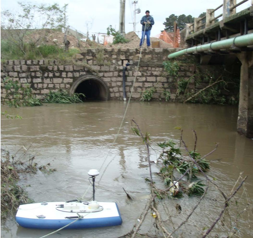
Figura 5 – Primeira medição de vazão no Arroio do Salso utilizando medidor acústico Sontek M-9.
