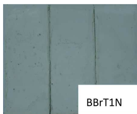
Figura 45 - Argamassas brancas fabricante B com sujidades por poluição após intemperismo natural
