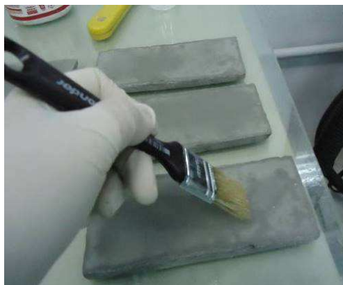
Figura 15 – Aplicação de tratamento superficial sobre as placas de argamassa de rejuntamento
