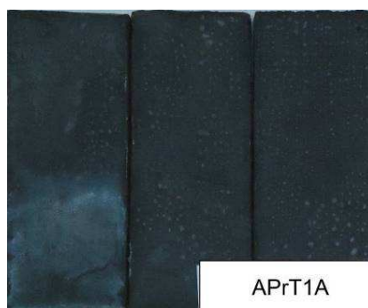
Figura 50 – Argamassa preta fabricante A com tratamento à base de metil siliconato de potássio após envelhecimento artificial
