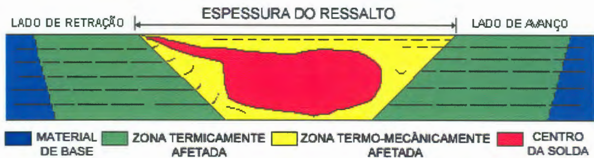
Figura 2.4 – Desenho esquemático onde se podem observar as 4 principais regiões obtidas após a solda (9) .
