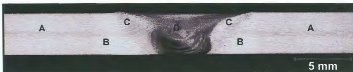
Figura 4.1 – Macrografia da solda na condição T4O. Em (A) temos o material de base, em (B) a ZTA, em (C) a ZTMA e em (D) centro da solda. Ataque: reagente Flick.
