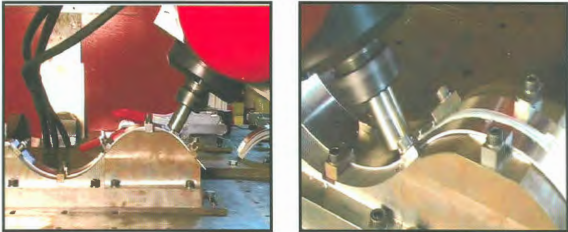
Figura 2.9 – Fotografia da soldagem de uma superfície não plana (20) .
