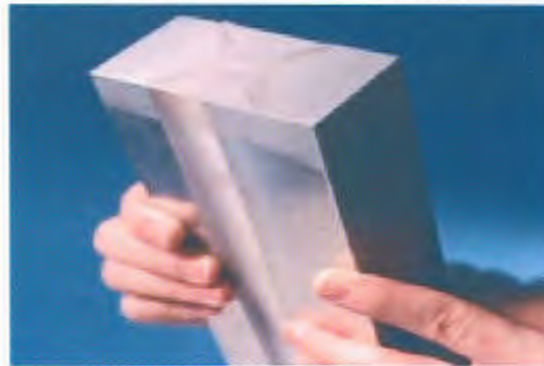
Figura 2.7 – Imagem mostrando a soldagem realizada através de dois passes com espessura de aproximadamente 120 mm (18) .
