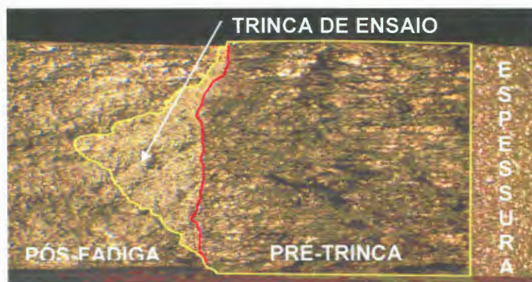
Figura 3.11 – Imagem da superfície de fratura de um corpo de prova após a pós-fadiga. Observam-se as três regiões, a da pré-trinca de fadiga, a trinca do ensaio e a da pós-fadiga.
