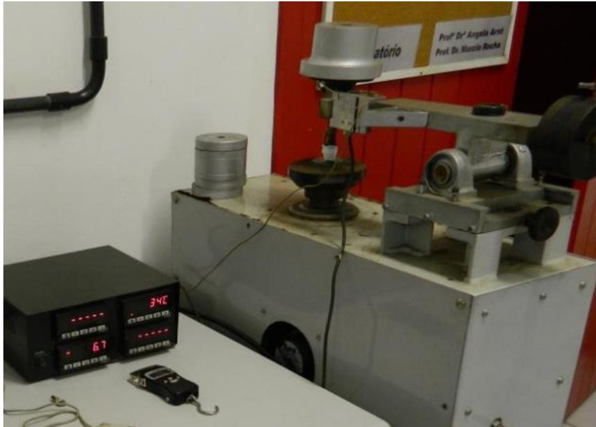
Figura 28 - Máquina de desgaste tribológico pino sob disco, utilizada no experimento.
