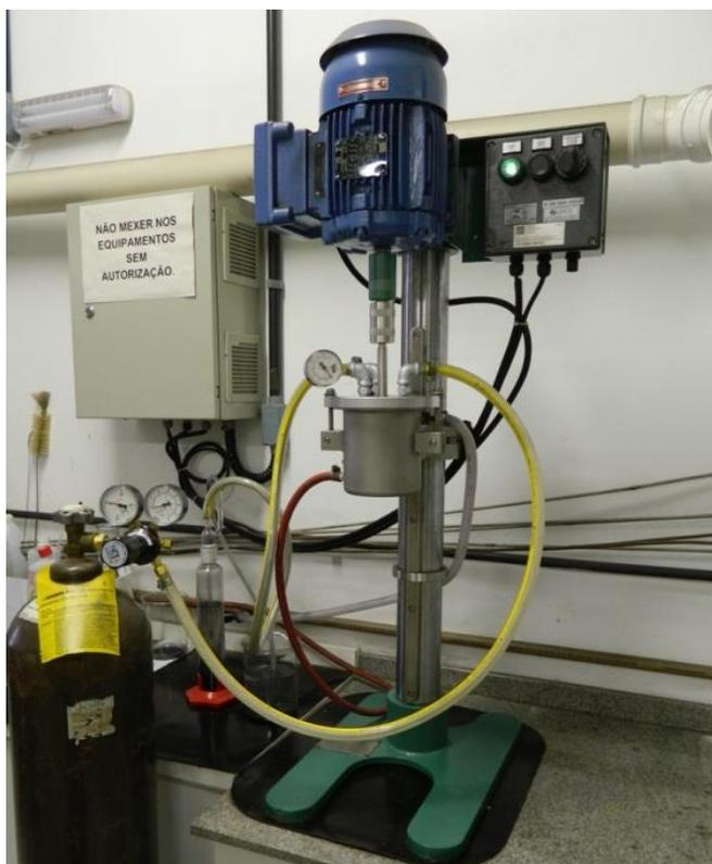
Figura 22 - Moinho de alta energia Netzsch modelo PE075, com atmosfera controlada, utilizado no desenvolvimento do trabalho Lafen/UNESC.
