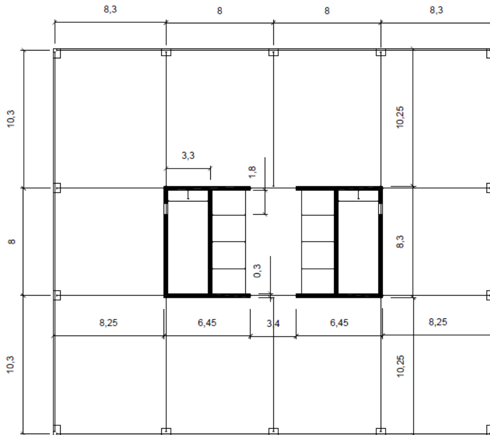
Figura 9 – Lançamento da estrutura do edifício com núcleo
