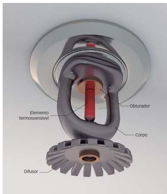
Figura 3– Sprinkler tipo spray
