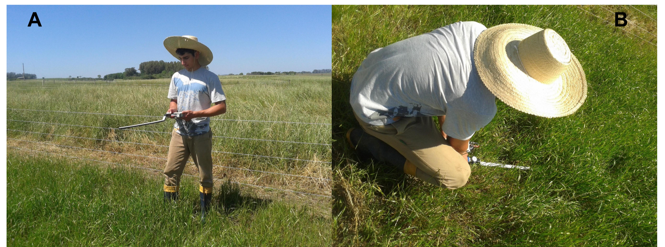
Figura 3 A e B: Medidas de interceptação luminosa com auxílio do Ceptômetro Decagon AccuPAP LP-80.
