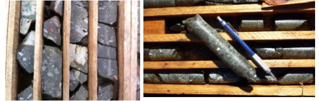
Fig. 2: Furos de sondagem coletados em trabalho de campo. A) Amostra vulcânica da jazida Santa Maria; B) Amostra vulcânica da mina São Luiz; ambas com textura afanítica e vesículas preenchidas por quartzo e carbonato.
