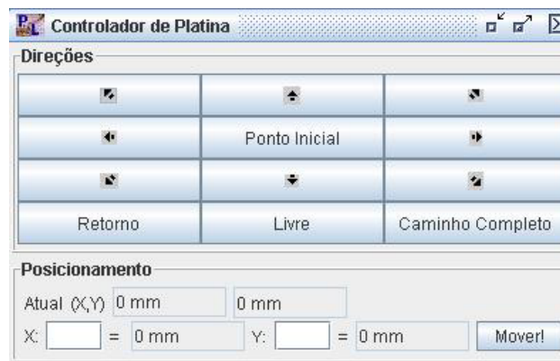
Figura 4.3: Interface visual do controlador da platina eletrônica.
