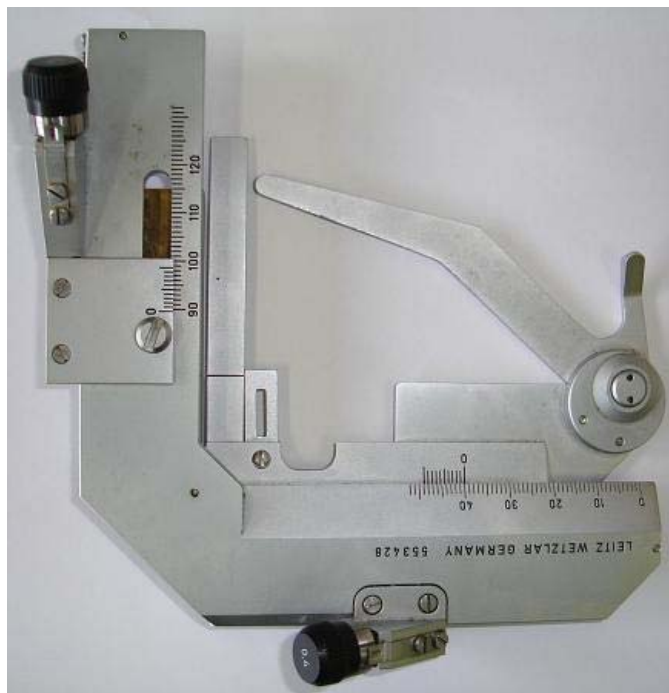
Figura 3.3: Charriot manual utilizado para movimentação da lâmina em microscópios petrográficos.
