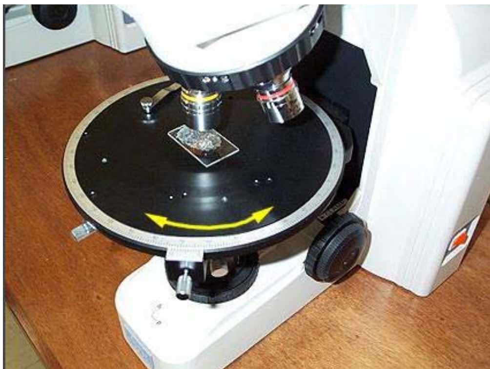
Figura 3.2: Microscópio com base rotacional.
