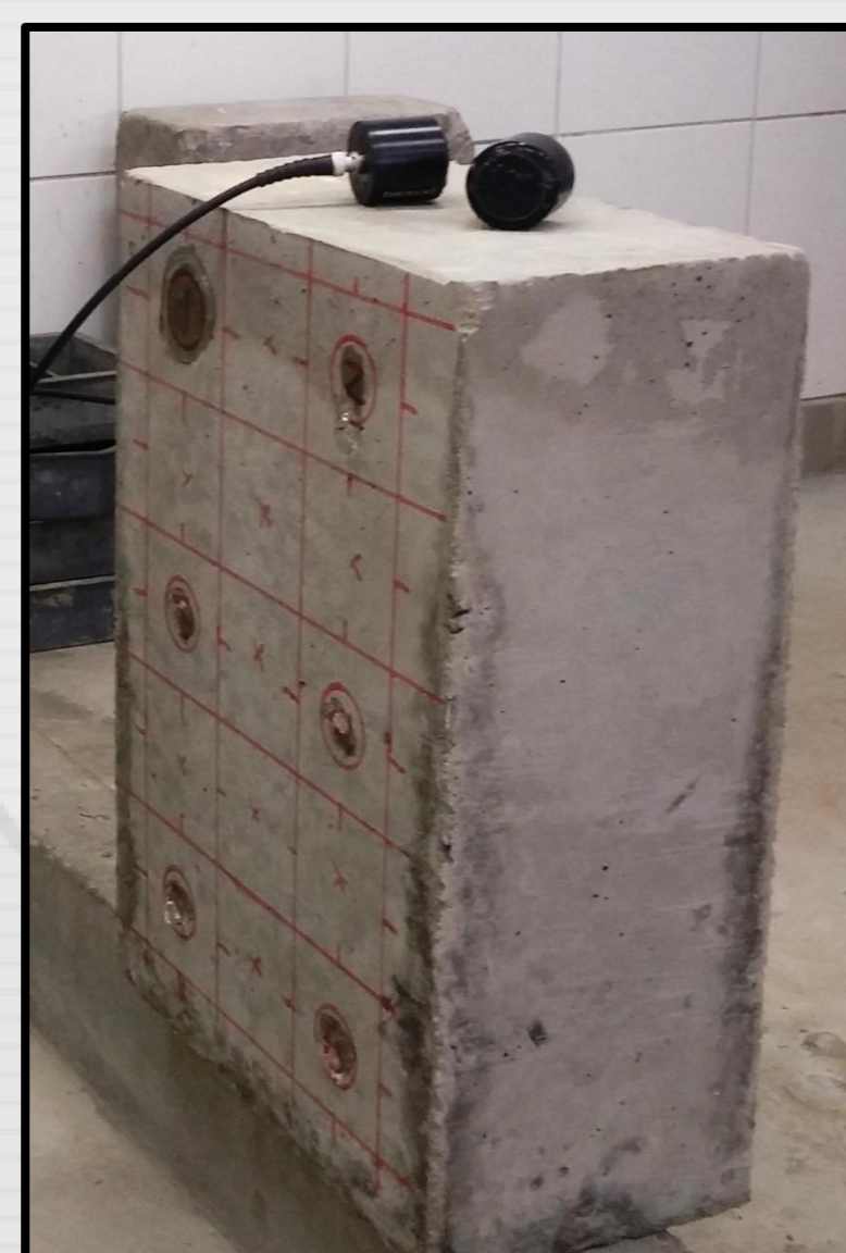
ENSAIO DE ULTRASSOM NO BLOCO
