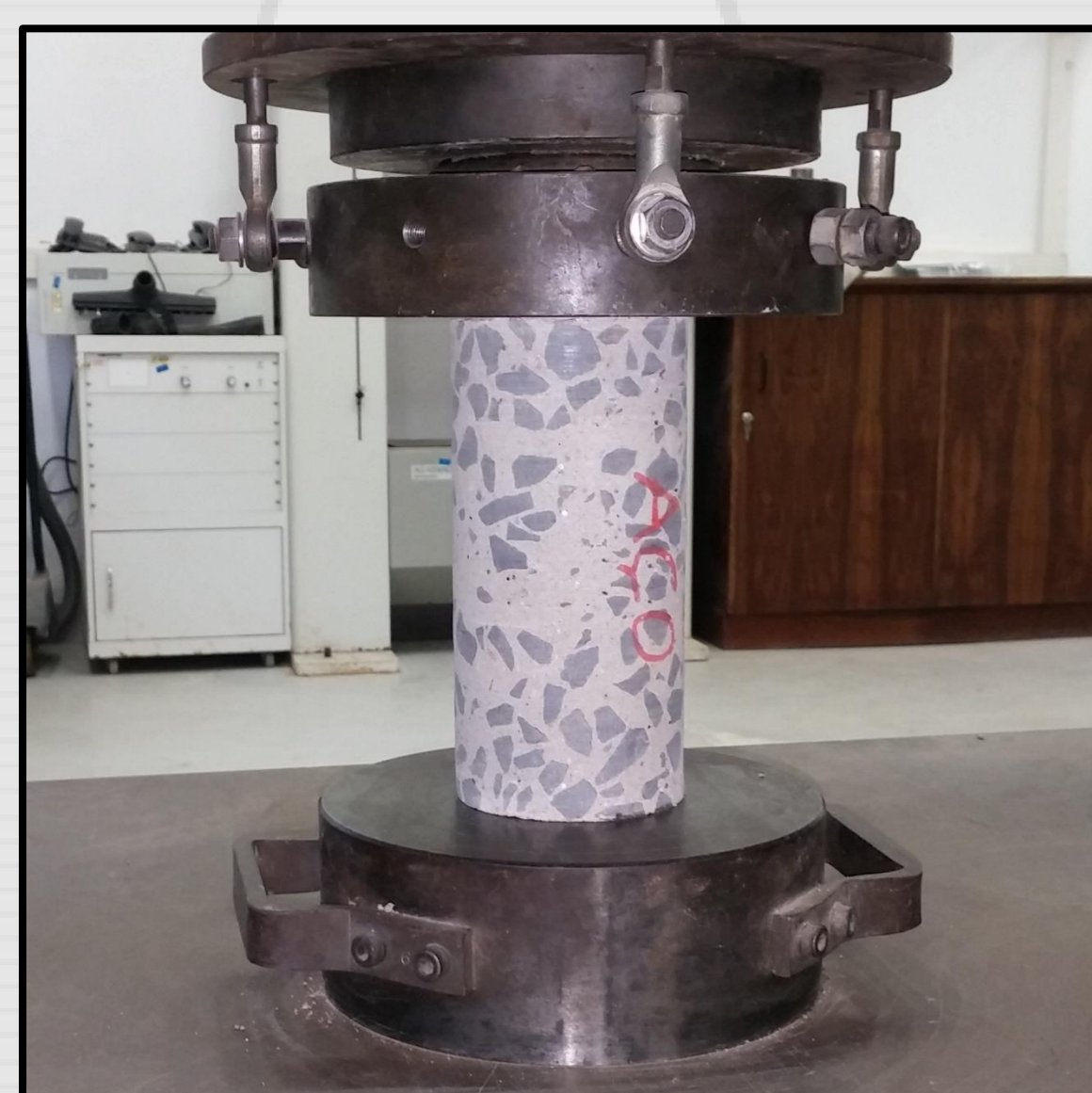
ENSAIO DE COMPRESSÃO AXIAL
