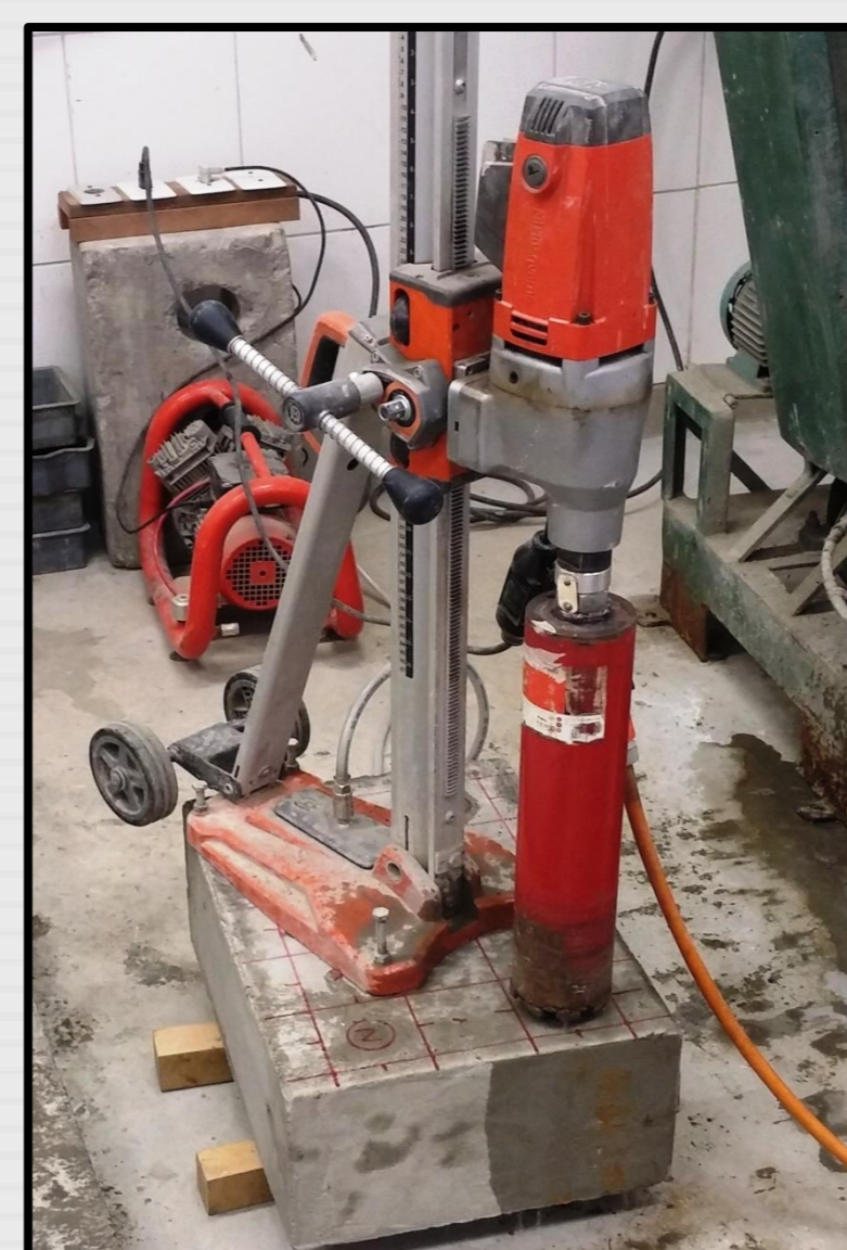
EXTRAÇÃO DOS CORPOS DE PROVA
