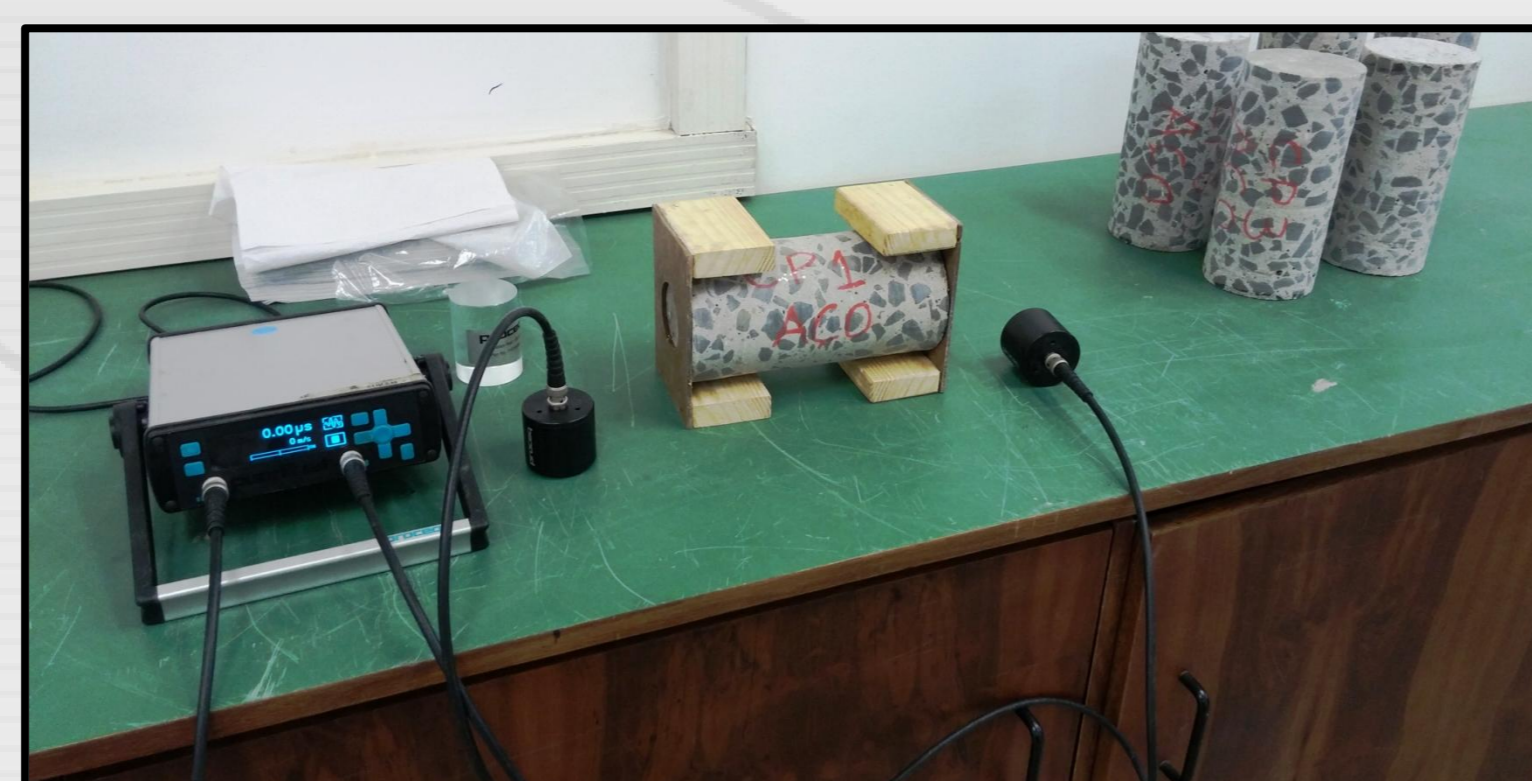
ENSAIO DE ULTRASSOM NOS CORPOS DE PROVA EXTRAÍDOS
