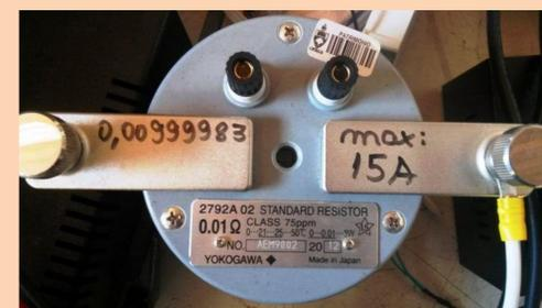
Resistor shunt de 0,01 ohms. Com medida de corrente máxima de 15A.
