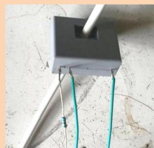
O sensor de corrente utilizado foi o CSNF661. Em destaque, o resistor de 18,011 ohms.
