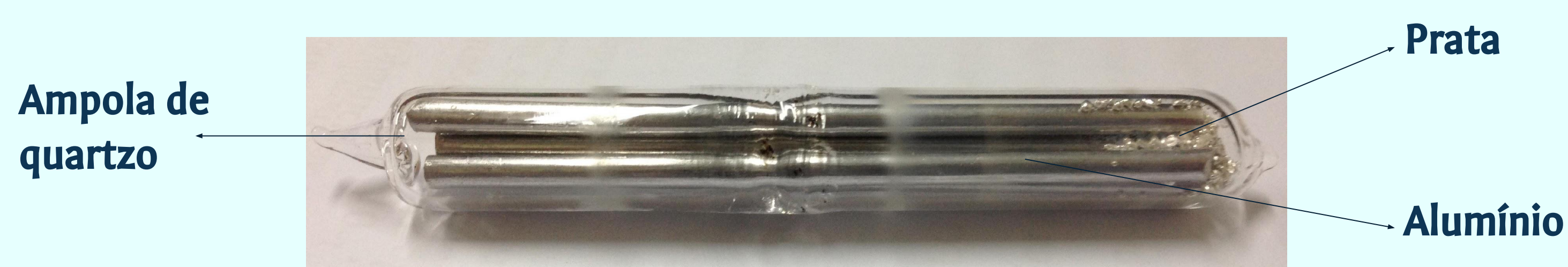
Figura 1. Ampola de quartzo selada à vácuo preenchida com Al e Ag
