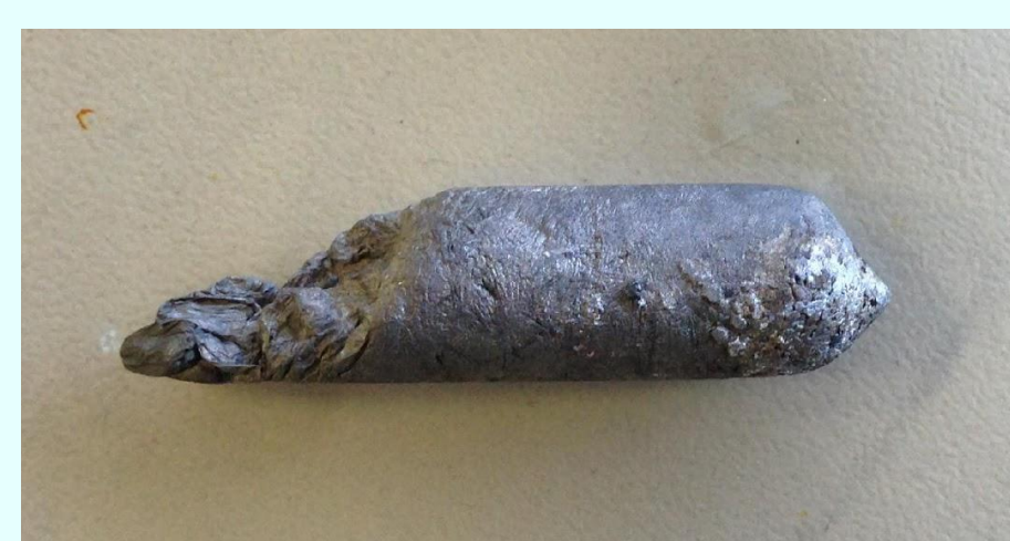
Figura 2. Liga metálica obtida após a fundição dos metais
