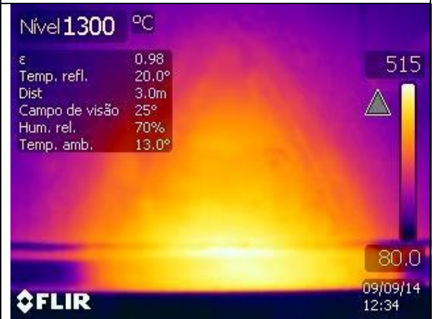
Figura C.29 – Imagem termográfica do ciclo térmico no instante t=1920s .
