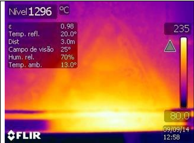
Figura C.33 – Imagem termográfica do ciclo térmico no instante t=3360s .
