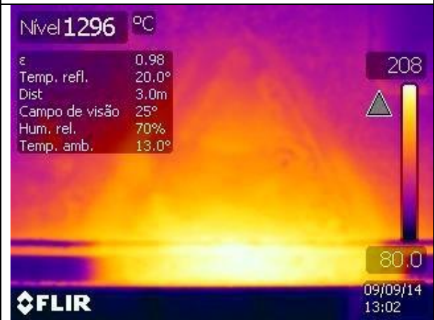
Figura C.35 – Imagem termográfica do ciclo térmico no instante t=3600s .
