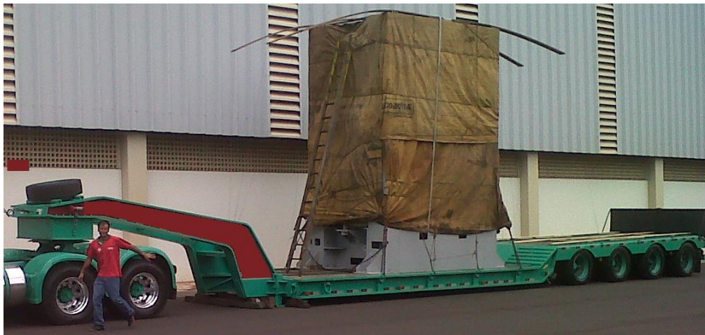
Figura 15 - SR CT com perda no arqueamento da viga.
