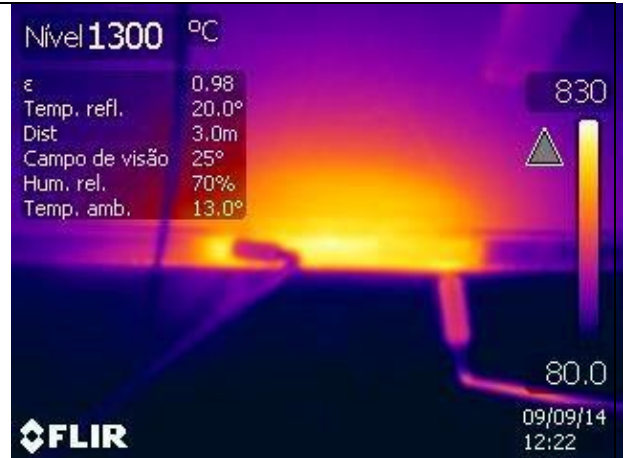
Figura C.15 – Imagem termográfica do ciclo térmico no instante t=1220s .
