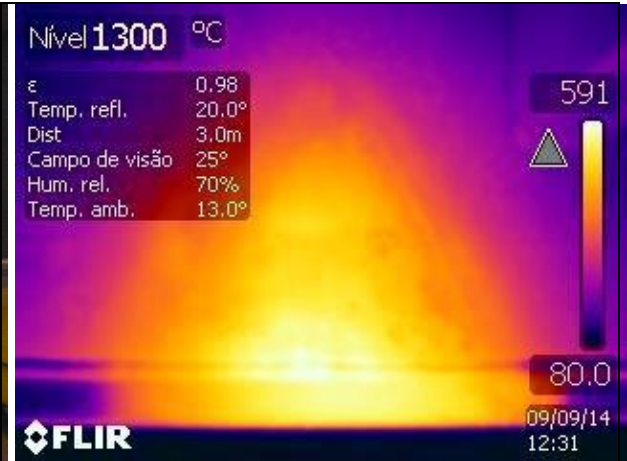
Figura C.27 – Imagem termográfica do ciclo térmico no instante t=1740s .
