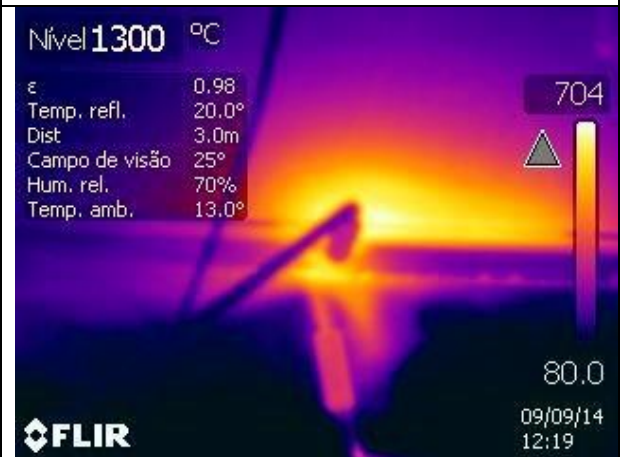
Figura C.7 – Imagem termográfica do ciclo térmico no instante t=1020s .
