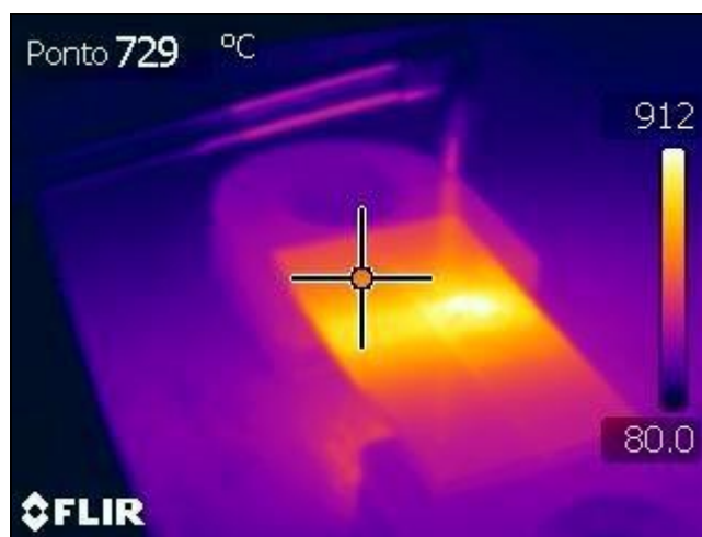
Figura 42 - Monitoramento da temperatura de aquecimento através da câmera termográfica. Fonte: Autor.
