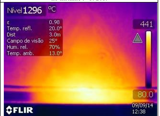
Figura C.31 – Imagem termográfica do ciclo térmico no instante t=2160s .
