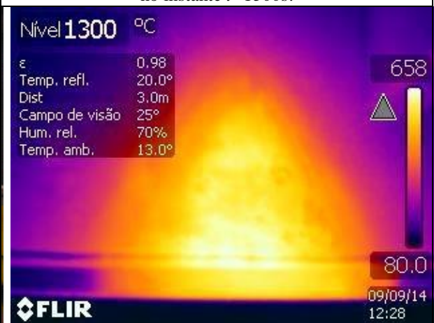
Figura C.25 – Imagem termográfica do ciclo térmico no instante t=1560s .
