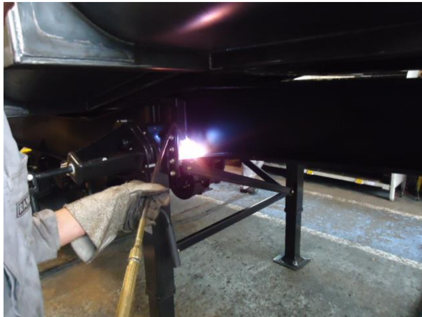
Figura 26 - Região de aplicação da chama de oxiacetileno para o correto desempenho. Fonte: Randon Implementos S.A. (2012).
