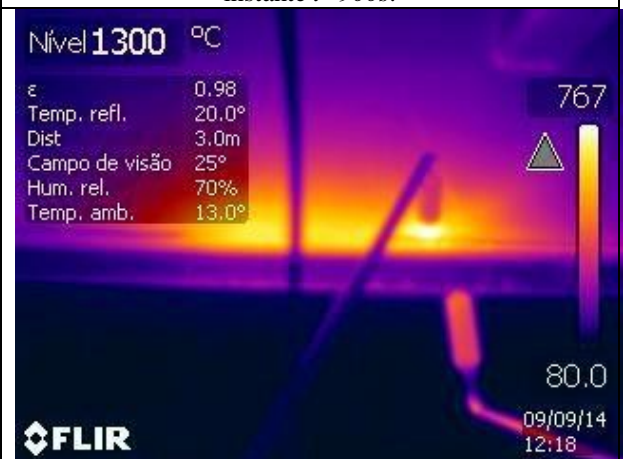
Figura C.5 – Imagem termográfica do ciclo térmico no instante t=960s .
