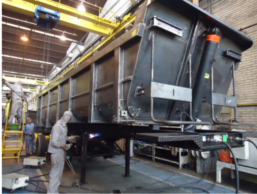
Figura 25 - Alinhamento a quente entre caixa de carga e chassi de um SR BA. Fonte: Randon Implementos S.A. (2012).
