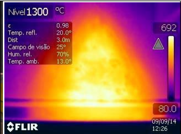
Figura C.21 – Imagem termográfica do ciclo térmico no instante t=1480s .
