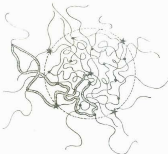
Figura 5: Representação esquemática de um reticulado. A circunferência tracejada tem um raio igual a distância entre os extremos de uma cadeia. As estrelas representam os vizinhos topológicos e os círculos, os vizinhos espaciais. A linha dupla representa o caminho mais curto entre dois vizinhos espaciais. (Bastide et al.) 22
