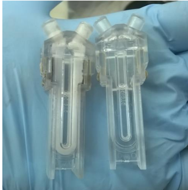
Figura 5.19. Cubetas utilizadas na análise de potencial Zeta. À esquerda, recipiente degradado pelo solvente NMP impossibilitando a medida; à direita, a fim de comparação, uma cubeta antes do uso.
