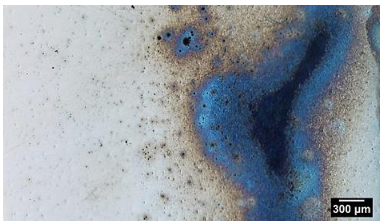
Figura 4.38 Superfície das amostras corroídas em 20%MEG, em magnificação de 50x.
