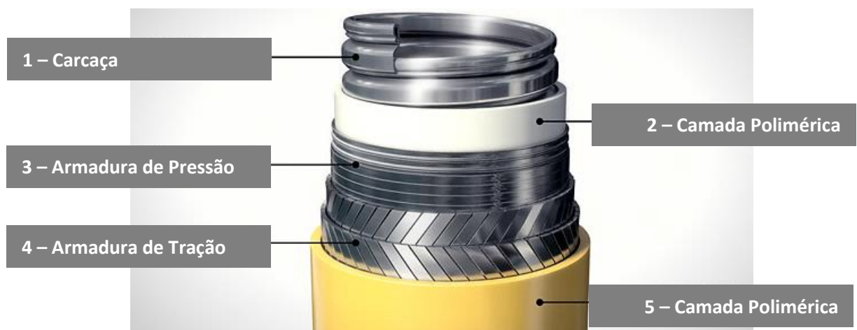
Figura 2.2 Típica composição de um riser flexível unbonded . Fonte: adaptado de NOV DYNAMIC FLEXIBLE RISERS .
