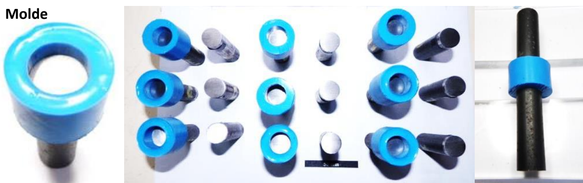
Figura 3.3 Corpos de prova com o molde de silicone acoplado, para moldagem da resina nos corpos de prova.
